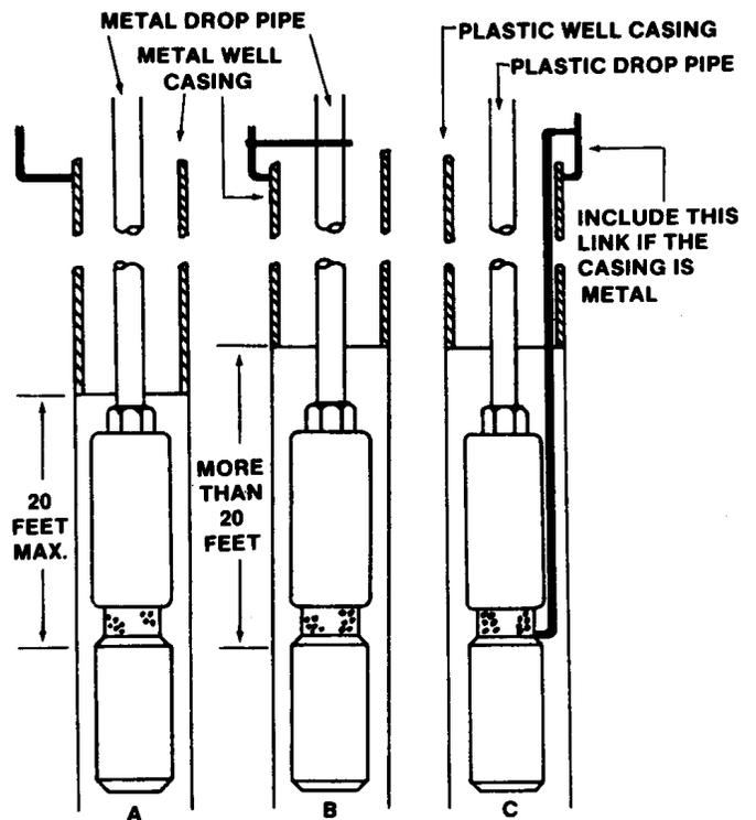
FIGURE 9. ARRANGEMENTS FOR GROUNDING LIGHTNING ARRESTORS
