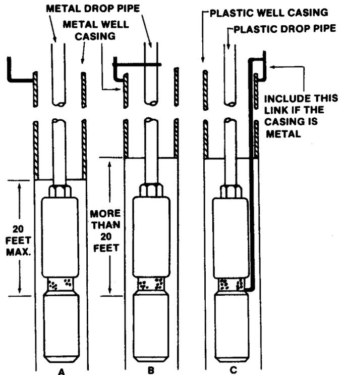
FIGURE 9. ARRANGEMENTS FOR GROUNDING LIGHTNING ARRESTORS
