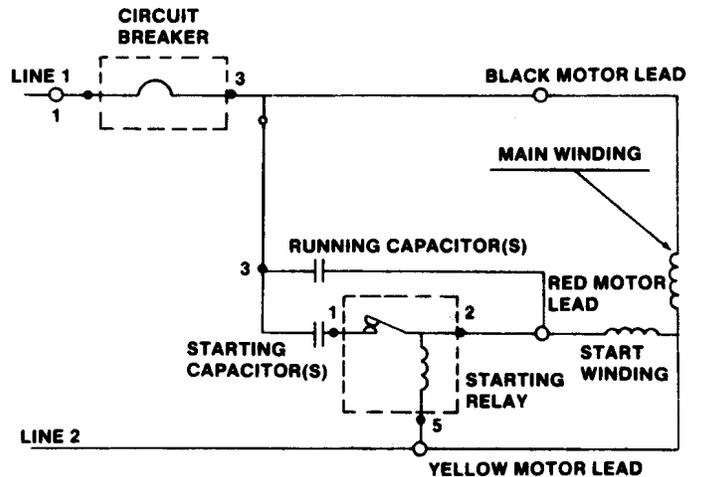
**FIGURE 7. CONTROL BOX COMPONENTS AND WIRING, 1 ½ HP AND LARGER MOTORS**
